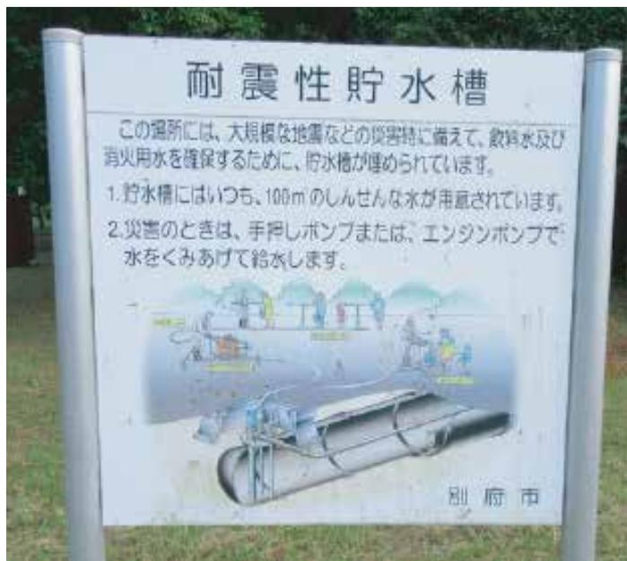
「大地震など災害が起こった場合、停電などによりしばらくの間水道施設の機能が停止し、断水になることが予想されます。そういった場合に備えて別府市では地震に対して十分な強度を持ち、耐久性があり、衛生的にも安全であって、また水道水として必要な水質を確保する貯水槽を市民の避難場所となる公園及び小学校の地下に設置しています。これにより水道施設復旧までの間、市民の飲料水確保が可能となります。
