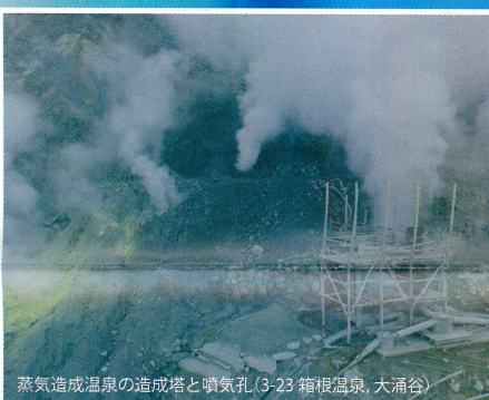
蒸気造成温泉の造成塔と噴気孔(3-23 箱根温泉、大涌谷)
